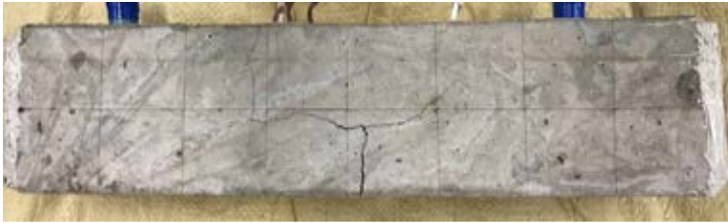
図-試験後のひび割れ発生状況 (シース径40mm、水充填)
