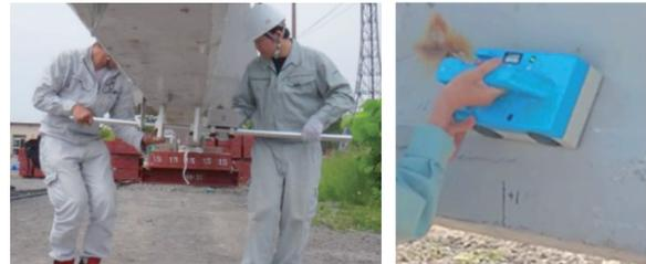
写真-3 漏洩磁束法の調査状況
