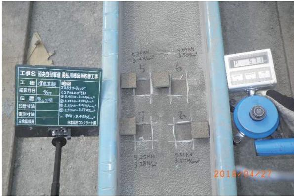
写真-6 ゴムラテコーティング付着強度引張試験状況
