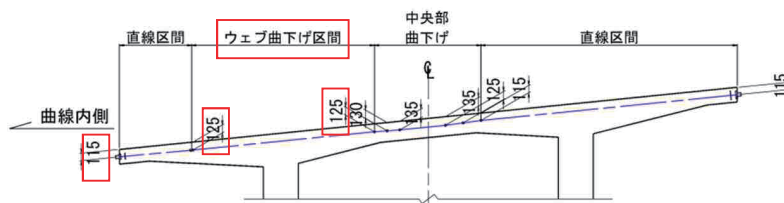
図－6 Eランプ橋横締めケーブルの配置
