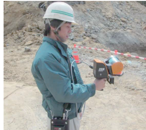
写真-2 ハンディタイプ レーザースキャナ
