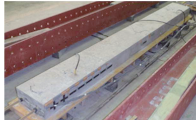
(a) 曲げ試験体（PC梁）
