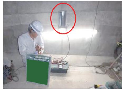
写真-3 桁内傾斜計
