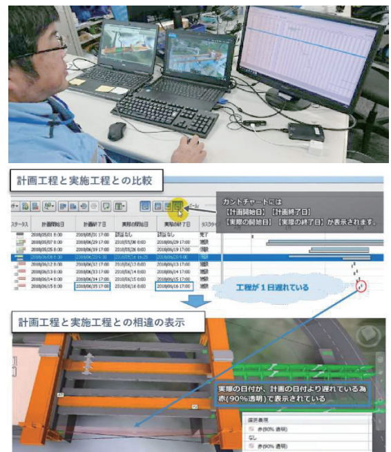
図-7 現場での4DCIMによる工程管理
