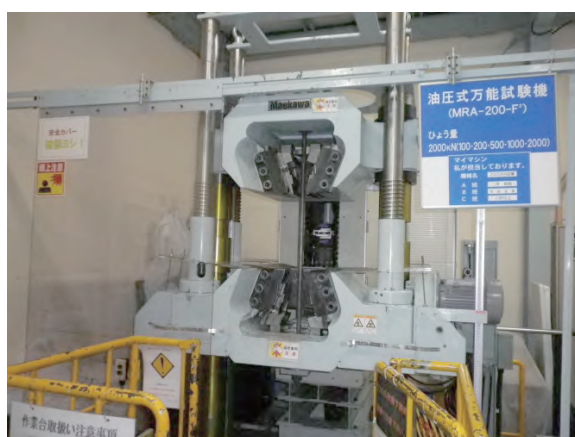
写真-1 定着効率試験の状況
