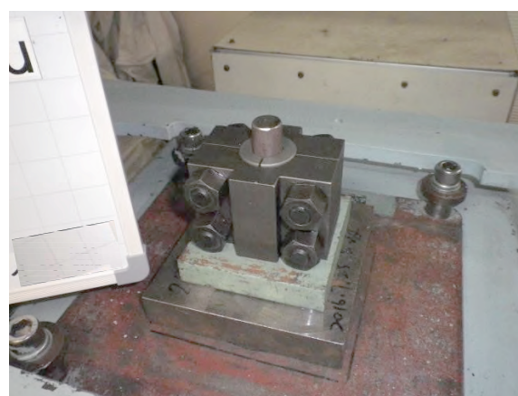
写真-2 定着具の状況（試験後）
