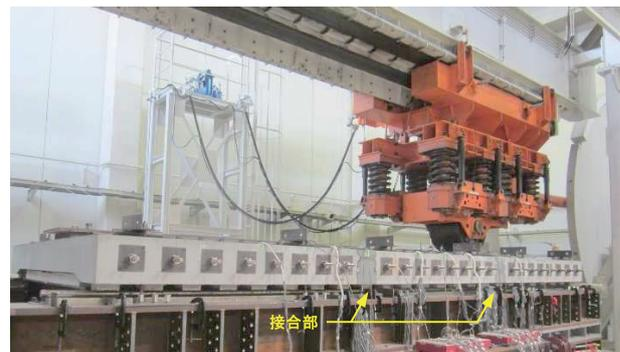
写真-2 スリムファスナー輪荷重載荷試験
