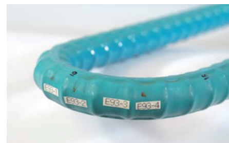
写真-4 発錆状況 (遮光ネット無し 曝露9ヵ月)
