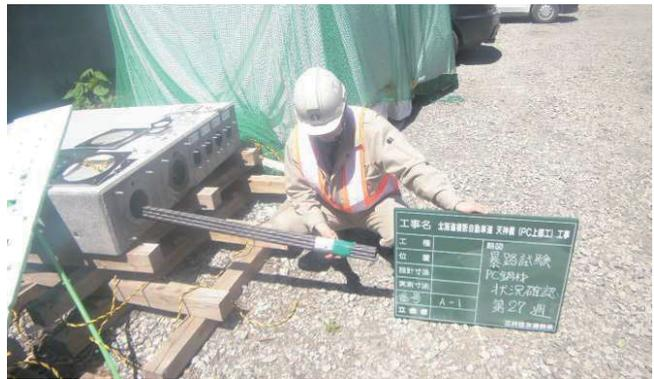
写真-2 暴露試験確認状況
