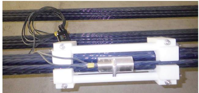
写真-5 磁気張力センサー設置状況
