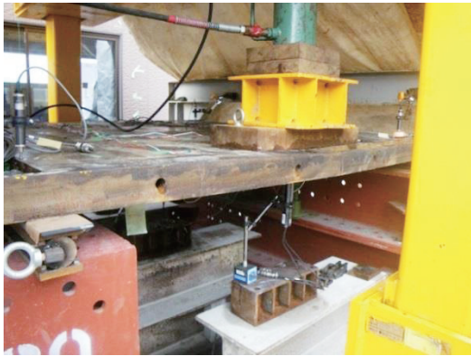
写真-6 載荷試験状況 (縁端部載荷)
