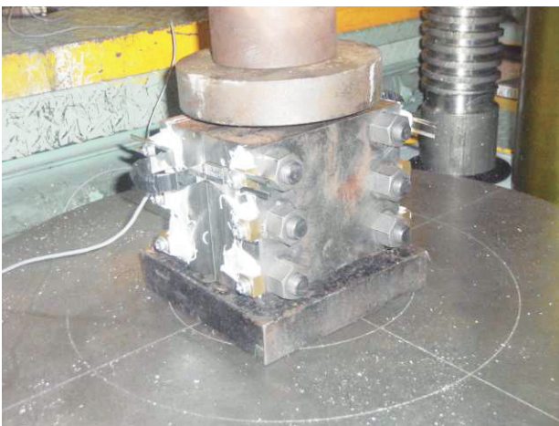
写真-3 ジャケット開き測定
