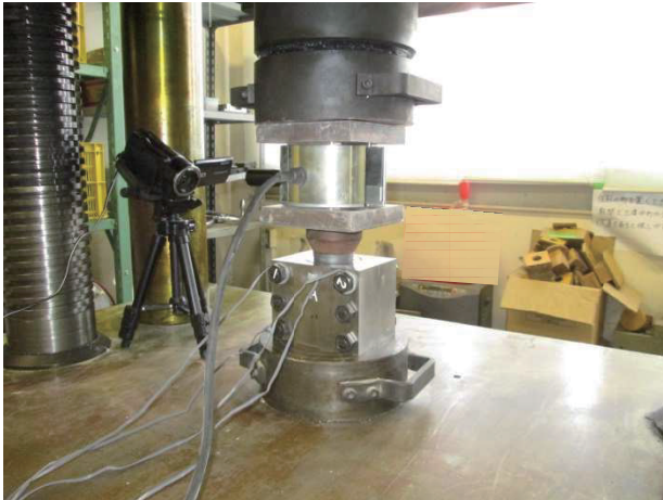
写真-2 ウェッジ押し込み試験
