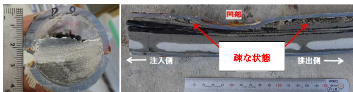
写真-5 供試体 D の切断面
