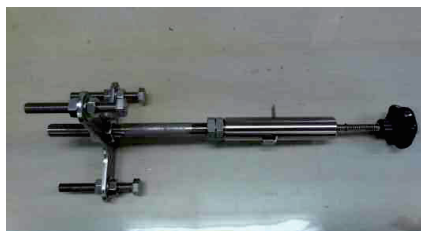
写真-5 バネ式の衝撃入力装置
