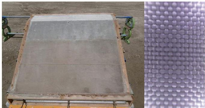
写真-6 織物タイプの表面状況と透水シート
