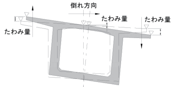
図-7 橋脚倒れによるたわみ
