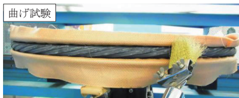
写真－2 本開発品の曲げ試験および引張破断試験結果
