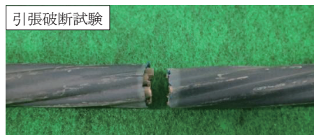
写真－2 本開発品の曲げ試験および引張破断試験結果
