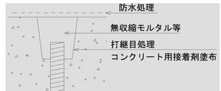
図-4 後埋め部の後処理・防水
