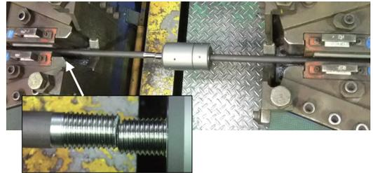
写真-2 特殊接続具の引張性能試験
