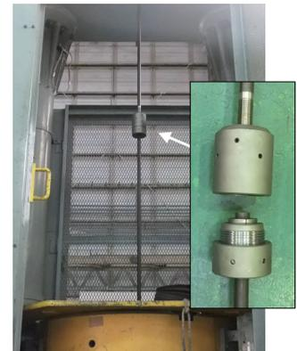
写真-3 特殊接続具の引張疲労試験
