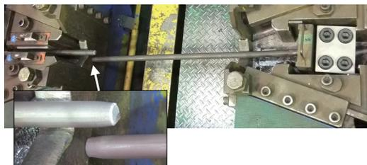
写真-1 中間定着具の定着性能試験
