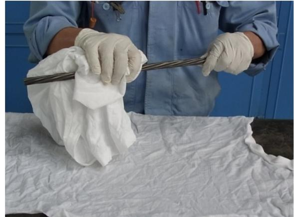
写真-3 乾布による表面水分の拭取り状況
