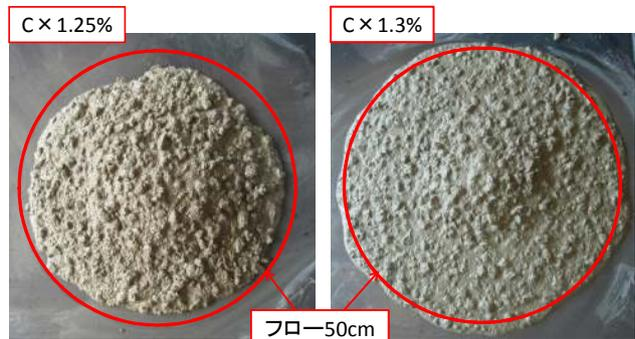
写真-1 中流動コンクリートのスランプフロー
