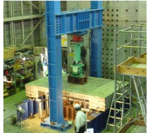
写真-4 静的載荷試験状況
