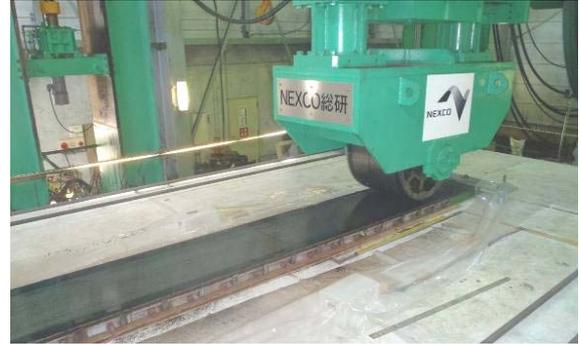
写真-3 輪荷重走行試験状況
