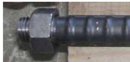
写真-1 ナット付き鉄筋
