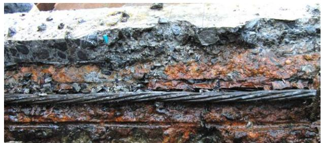
写真-1 試験体腐食状況(供試体C)
