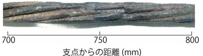
写真-2 より線の腐食状況(供試体 D2)
