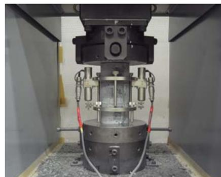
写真-2 圧縮試験の様子
