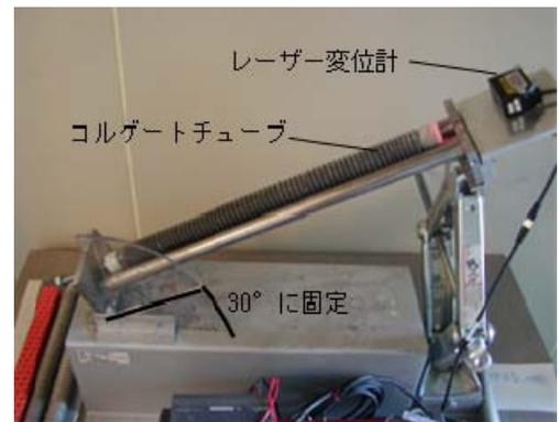
写真-2 長さ変化試験装置
