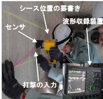
写真-3 インパクトエコー測定状況
