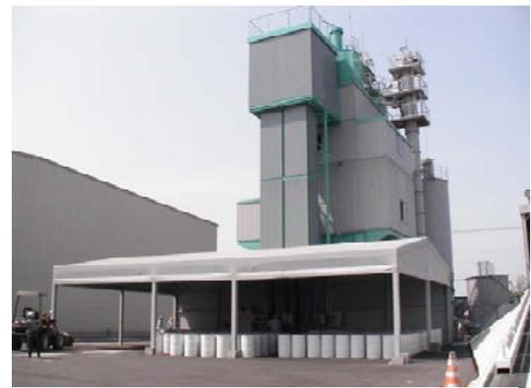
写真-3 UFC専用バッチャープラント
