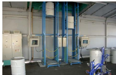
写真-4 ドラム缶ポーターによる鋼繊維供給
