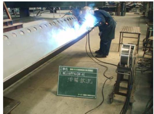
写真-2 鋼部材製作状況
