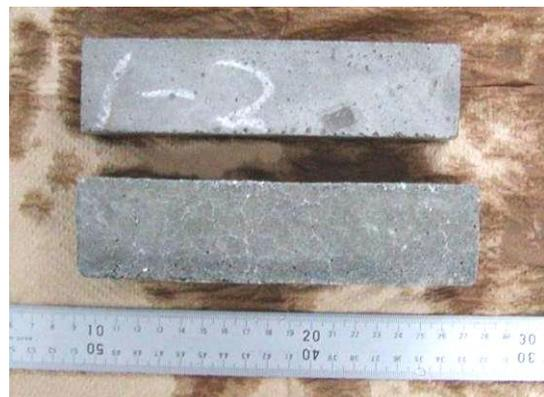
写真-4 膨張したモルタル (上: Nタイプ, 下: HP10%)
