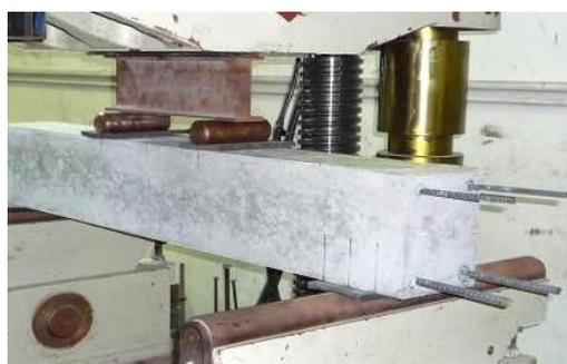
写真-1 2点曲げ載荷試験
