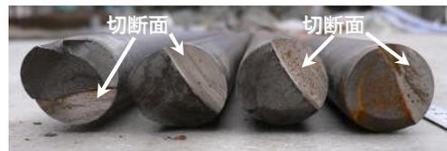
図-5 PC 鋼棒の破断面の状況
