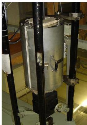
写真-2 加熱炉
