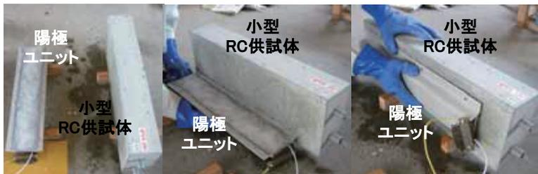
写真-3 陽極ユニットの組み込み
