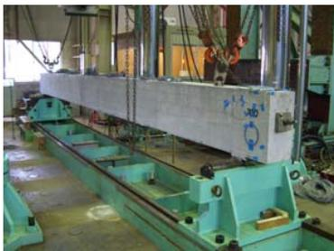
写真-1 載荷試験方法
