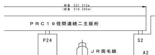
図-1 端径間構造変更図
