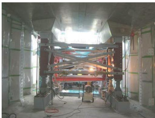
写真-2 水平反力載荷装置
