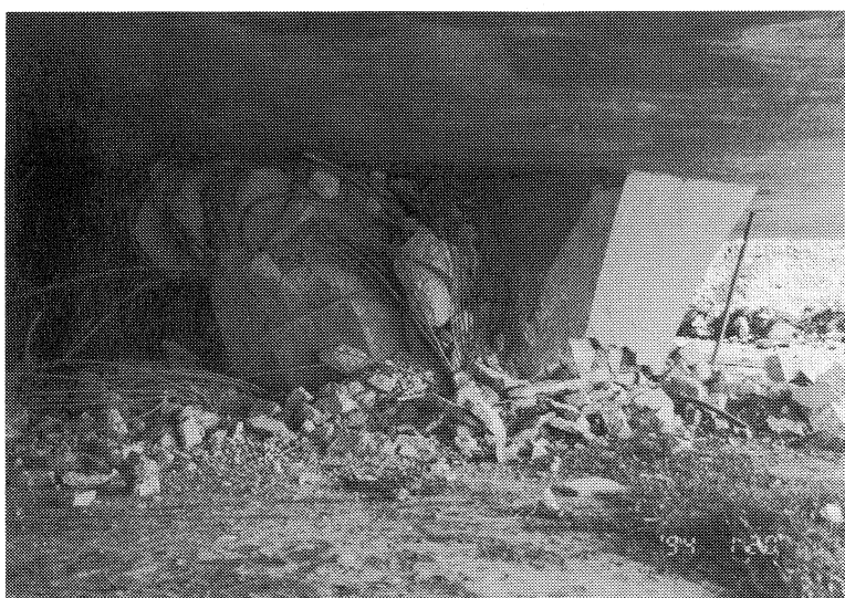
写真-7 最終的な破壊状態
